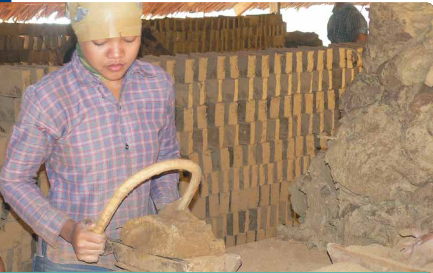
On travaille la terre glaise, puis on en fait des briques, qui sont ensuite séchées et cuites.
